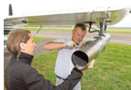
Rainer Schopf (Chef) und Julia Färber (Pilotin) bei der Kontrolle der Silberjodid-Generatoren am Flugzeug.
