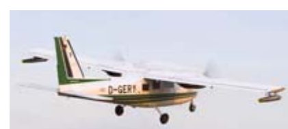
Das Flugzeug in der Luft mit den beiden Silberjodid-Generatoren links und rechts.
