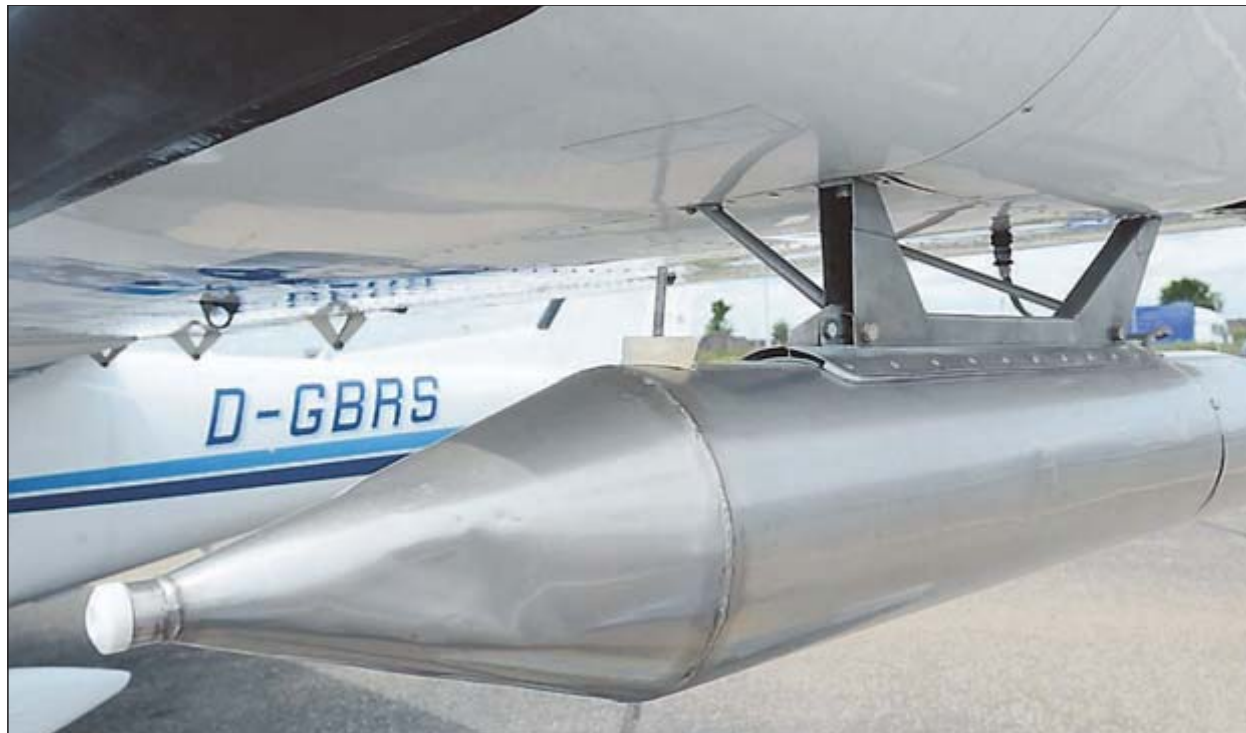
Ab Freitag hat der Hagelflieger wieder Saison. Die Hagelabwehr in der Region setzt in diesem Jahr wahrscheinlich eine weitere Maschine ein. Aus diesen seitlich angebrachten Generatoren, auch „Fackeln“ genannt, sprühen die Piloten Silberjodid in Gewitterzellen. Das führt dazu, dass anstelle großer Hagelkörner viele kleinere zu Boden fallen. Foto: NQ-Archiv
