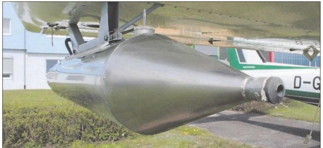
In dieser Düse ist das Gemisch aus Silberjodid und Aceton. An jedem Flügel befindet sich ein solcher Generator, dessen Kapazität für etwa zwei Flugstunden ausreicht.
