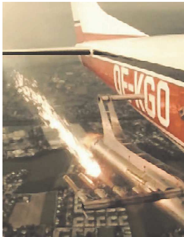
Holger Miconi ist einer der Hagelfliegerpiloten, die den Himmel über Schwenningen vor schwerem Hagel abschirmen (links). Er und seine Kollegen fliegen gefährliche Gewitterzellen an und sprühen mit solchen Brennern Silberjodidpartikel in die Wolkentürme, woraufhin diese abregnen. Dabei entsteht allenfalls feinkörniger Hagel, der für Menschen und ihren Besitz am Boden keine Gefahr mehr darstellt. Fotos: NQ-Archiv
